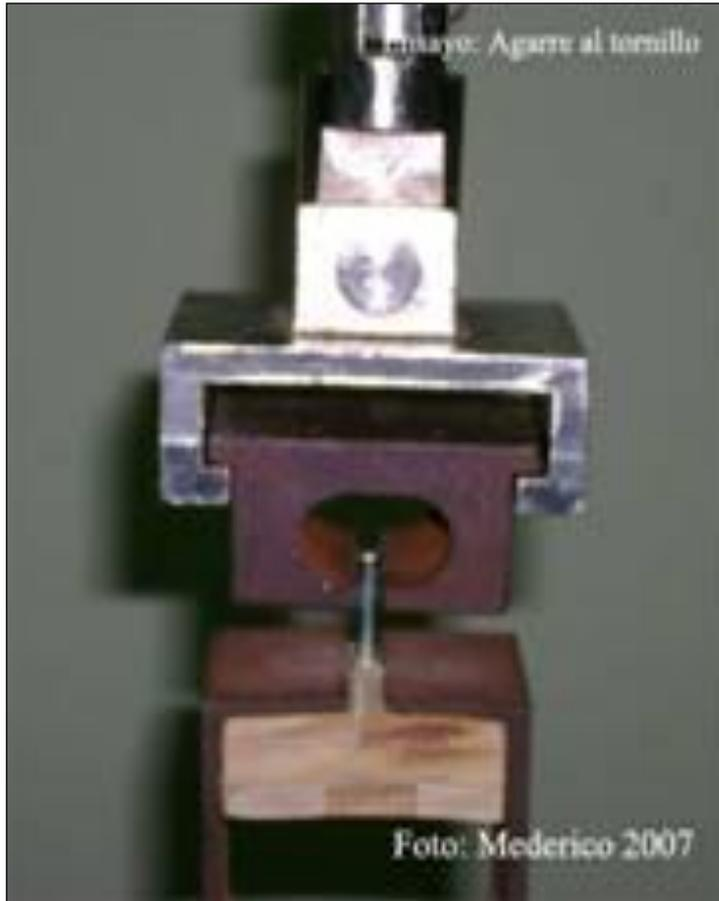
Resistencia a la tracción del tornillo por la cara
